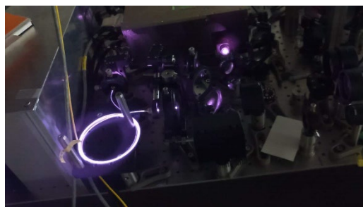
ファイバーラボ株式会社と協力して製 作した2 \mu\text{m} ファイバ増幅器
