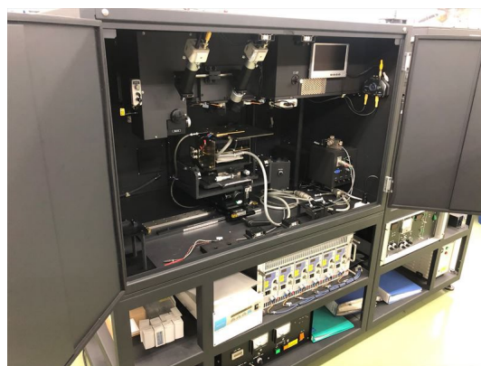
多接合太陽電池対応型分光感度特性測定装置
